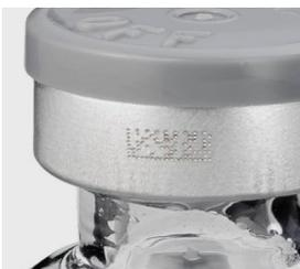
Gravur eines 2D-DataMatrix-Codes
